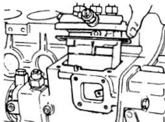
Installation d'une pompe d'injection
