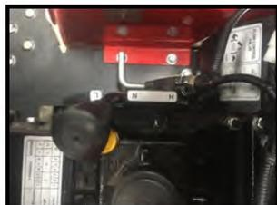
Levier de relevage Haute/Basse vitesse (high/low) en position point mort
