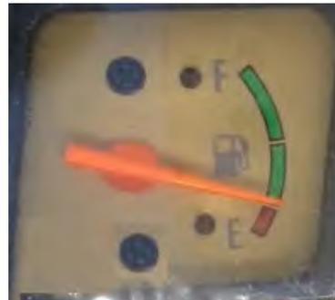
Indique le niveau de carburant présent dans le réservoir lorsque l'interrupteur à clé est en position d'alimentation de l'allumage.
