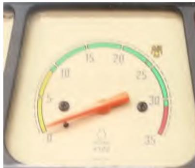
Ce compteur montre la vitesse de rotation du moteur et de l'arbre de prise de force, ainsi que la vitesse de déplacement au rapport le plus élevé. L'indicateur d'une valeur de 540 tours par minute (RPM) montre que l'outil est utilisé à une vitesse de 540 tours par minute.
