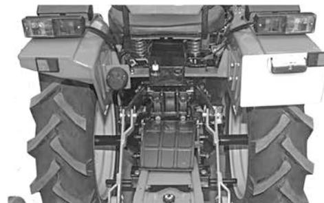
2. Retirer le support de barre supérieure au dos du boîtier de levage hydraulique et fixer le support de chaîne avec les boulons qui ont été utilisés pour le support de barre supérieure (schéma-3).
