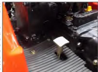
**PRUDENCE:** Éviter d'utiliser le blocage du différentiel lors de l'utilisation du tracteur à vitesse élevée ou sur la route.
