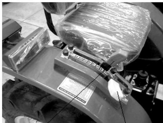
LEVIER CONTRÔLE DE POSITION Levier de profondeur/Contrôle de l'effort
