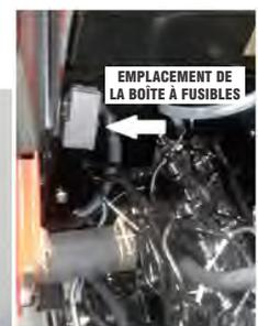
**PRUDENCE** – Utiliser un fusible de capacité adaptée uniquement lors du remplacement d'un fusible brûlé. De plus, ne pas utiliser de fil à la place de fusible. L'utilisation de fil pourrait causer des dommages au faisceau de câbles.
