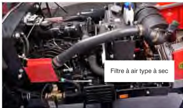
Lorsque l'élément du filtre à air est particulièrement souillé ou bouché, il peut empêcher le démarrage sans heurt du moteur ou détériorer ses performances, empêchant donc un fonctionnement normal. Il est important de toujours garder l'élément propre afin d'assurer une performance optimale du moteur.
