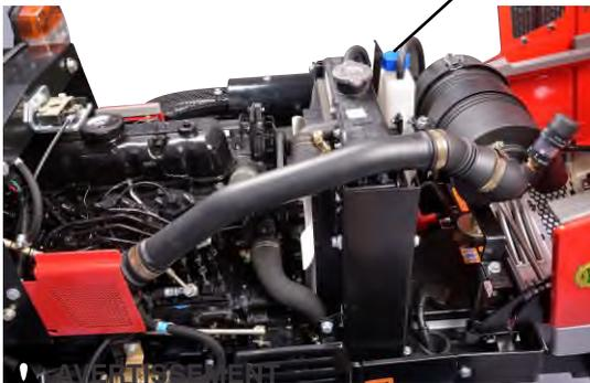
Retirer le bouchon du radiateur uniquement pour vérifier le niveau du liquide de refroidissement ou pour le remplir. Il est dangereux de retirer le bouchon immédiatement après utilisation du tracteur car de l'eau chaude pressurisée pourrait jaillir. Il est donc préférable d'arrêter le moteur et d'attendre jusqu'au refroidissement complet avant de retirer le bouchon.
