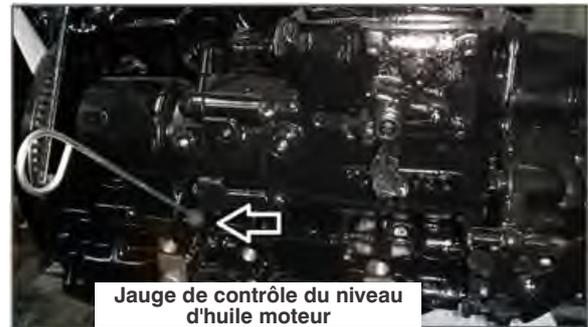
Vérifier le niveau d'huile du moteur à l'aide de la jauge de niveau d'huile du moteur. Il y a deux repères sur l'indicateur de niveau. Bas et Haut. Maintenir toujours le niveau d'huile du moteur au repère le plus haut. Le niveau doit être vérifié avant de démarrer le moteur ou 5 minutes après l'arrêt du moteur.
