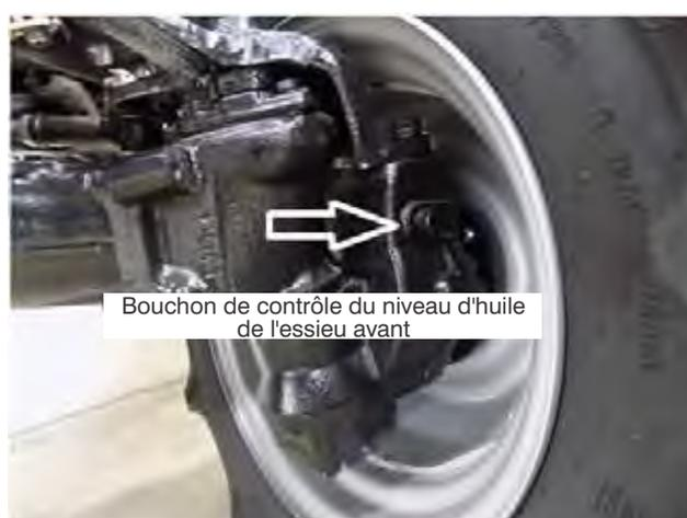
Pour le remplissage de l'huile de l'essieu avant, retirer le bouchon de niveau d'huile comme illustré sur la photo et procéder au remplissage d'huile.
