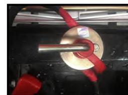
Une fois l'interrupteur du coupe-batterie arrêté, le capot se verrouillera. Utiliser la clé et la retirer.
